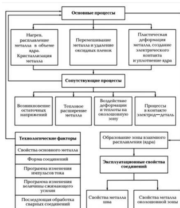
Рисунок 2 – Схема процессов образования соединений при контактной точечной сварке
